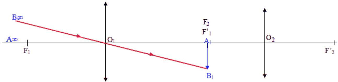
2) On prend 1 autre rayon, parallèle au 1<sup>er</sup> car  $B$  est à l'infini, il passe aussi par  $B_1$ . On hachure entre ces 2 rayons, c'est le faisceau lumineux
