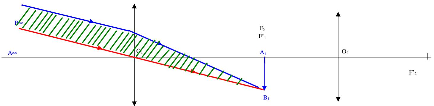
3) On construit l'image de  $A_1B_1$  à travers la 2<sup>ème</sup> lentille. Un rayon suffit (le noir), car l'image va être à l'infini comme  $A_1B_1$  est dans le plan focal objet de la 2<sup>ème</sup> lentille.
