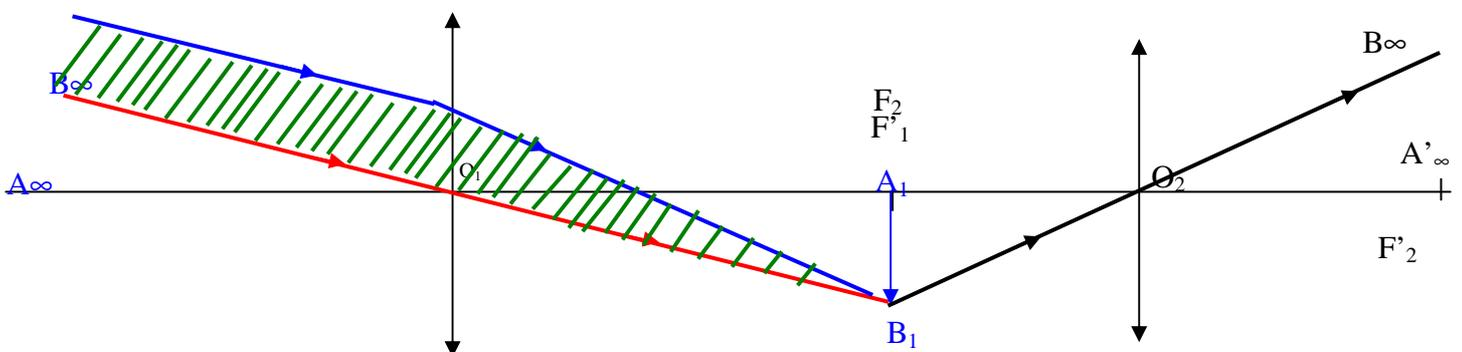
4) Il suffit alors de tracer la marche du rayon rouge et bleu à travers la 2<sup>ème</sup> lentille, en sachant que tous les rayons ressortent par la 2<sup>ème</sup> lentille, en étant parallèle
